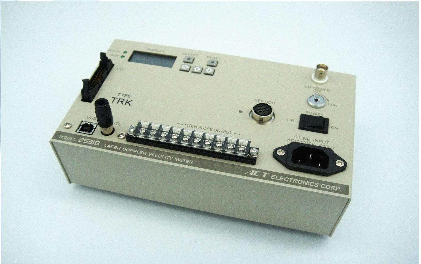
本器は、レーザドップラ方式の非接触速度・長さ測定器です。従来の接触測定や間接測定に比べスベリが発生したり製品にキズを付けたりしませんので、高精度に速度・長さ測定や速度制御を行うことができます。また、表面状態や色にも影響されませんので測定対象が広範囲な他、小型・軽量・操作の簡略性及び低価格化を実現していますので製造ラインで手軽にご使用いただけます。
