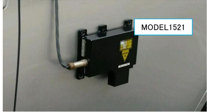
右 Bセンサ:MODEL1521N 焦点距離:500mm±80mm
