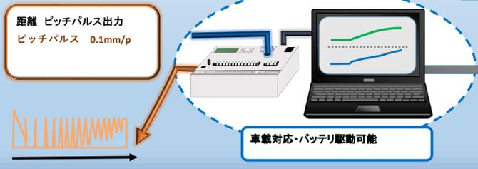
ドップラ方式は速度ゼロまで正確に測定可能。
