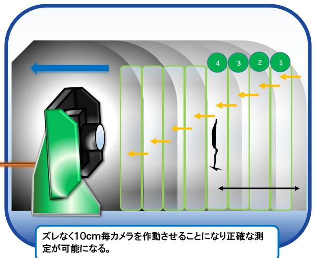
上記4回目の撮影時に亀裂を発見。結果として起点より40cmポイントと判明する。
