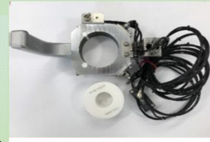
測定治具 電気マイクロメータ使用
