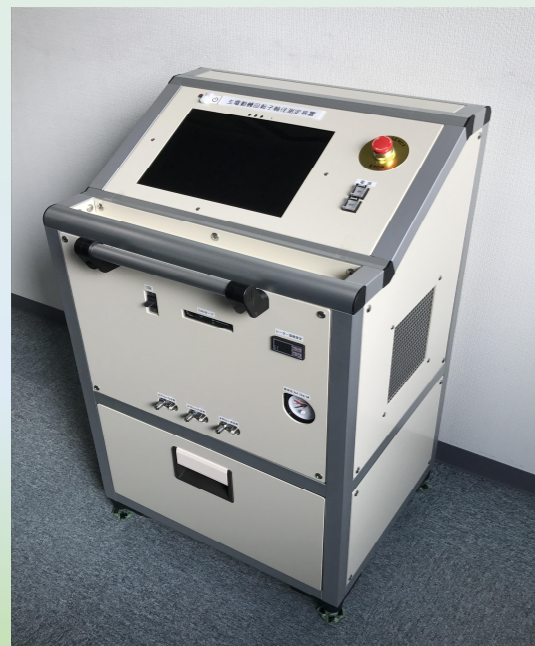
測定治具 電気マイクロメータ使用
