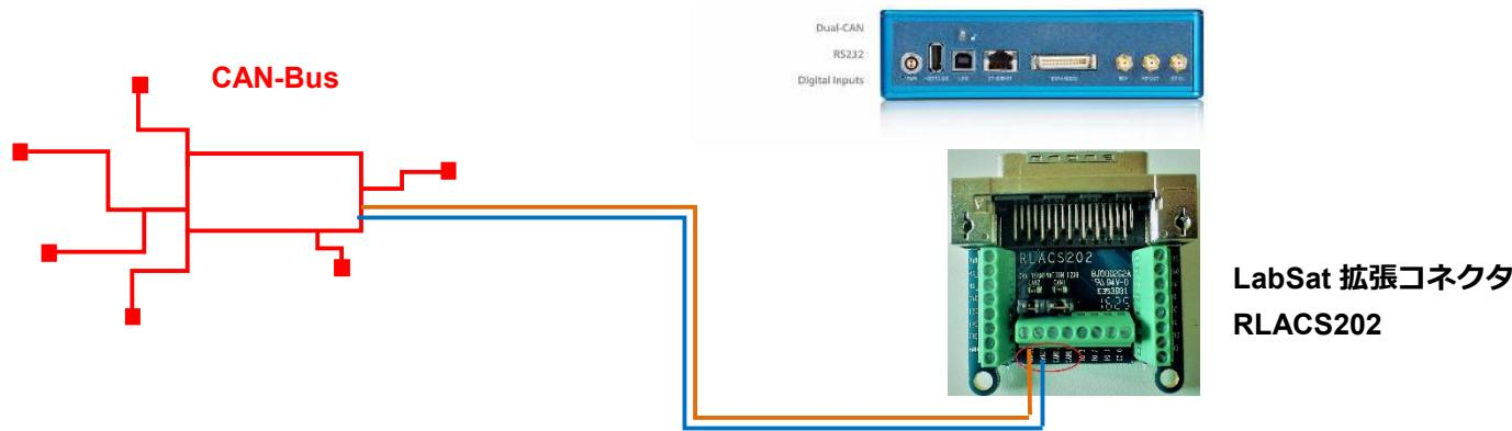
拡張コネクタには、 $120\Omega$  終端抵抗のジャンパーが備わっています。接続する CAN-Bus の仕様に合わせて、有り/無しを切り替えてください。多くのケースで、再生時には  $120\Omega$  終端抵抗は必要です。
