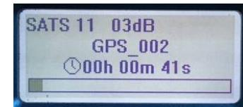
再生中に、OK ボタンを押すと、内部 GNSS 受信機によって捕捉された衛星信号レベルのバーグラフが表示されます。内部 GNSS 受信機は、現在は GPS と GLONASS のみに対応しています。このことは BeiDou からの信号を記録・再生には影響を与えず、BeiDou の記録再生に問題はありません。バーグラフ表示中に、▲▼ボタンで GPS と GLONASS の表示を切替えできます。表示を切り替えた場合は、内部 GNSS 受信機が衛星信号レベルを再度認識するために少し時間がかかります。特に GLONASS を選択した場合は衛星信号情報を表示するまでに 1 分以上(長い時で 1 5 分程度)かかります。
