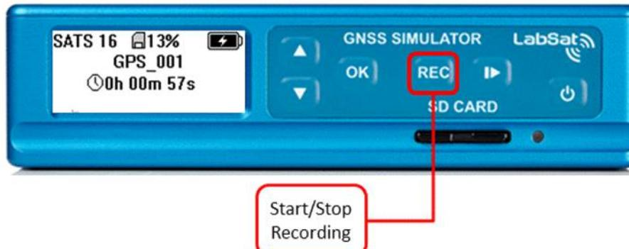
内部バッテリーを使って記録すると、GNSS モニターは設定された時間が経つと終了し、記録状態の表示に戻ります。この省電力機能は OFF にすることができますが、バッテリー駆動時間を長くするために ON にしておくことをお薦めします。
